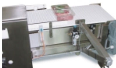
Option: Förderband mit pneumatischem Pusher (für verpackte Ware)
