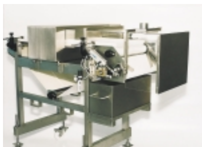
Option: Förderband mit Auswurfklappe am Bandende (für lose Ware)
