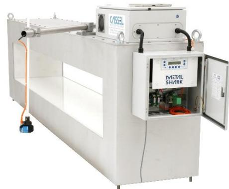
METAL SHARK BIG pba mit Super Power Drive für eine genauere Metallerkennung und eine Bandnahterkennung zur Reduzierung von Fehlalarmen
