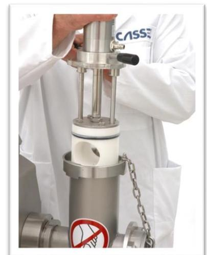
Kolbenventil zur zuverlässigen Ausschleusung von verschmutzten Produktteilen.
