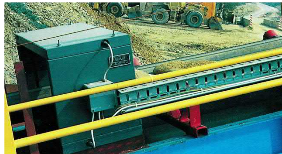
Metalldetektor SQTA als Tandemsonde.
