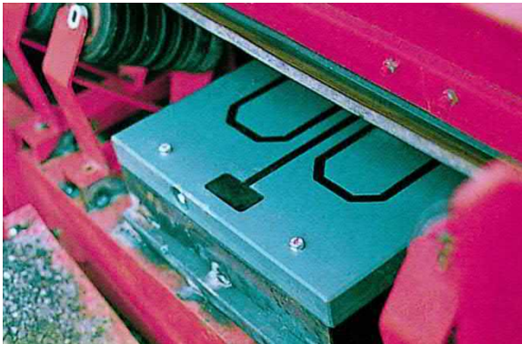
Metalldetektor SQ als Einzelsonde unter dem Förderband montiert.
