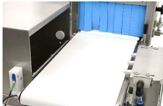
XD28-L1 mit Luftdruck-Pusher-System und Auswurfbehälter.
